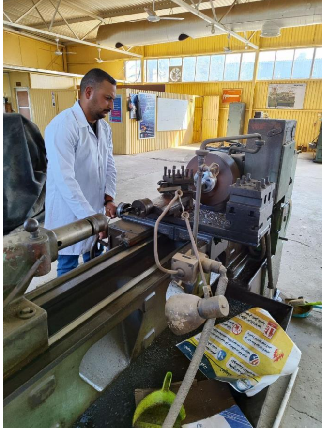
شكل 3.4 يوضح خراطة الجزء الخارجي من المحرك
