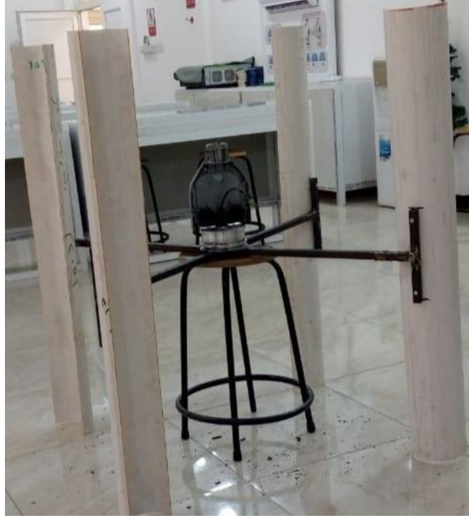
الشكل 3.5 يوضح تثبيت حامل الشفرات على المحرك
